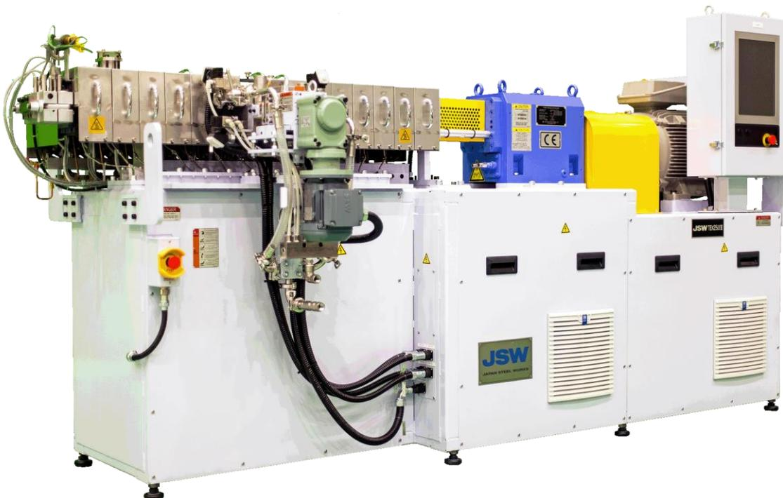
**TEX25alll, co-rotating twin-screw extruder , gleichlaufender Doppelschneckenextruder**
